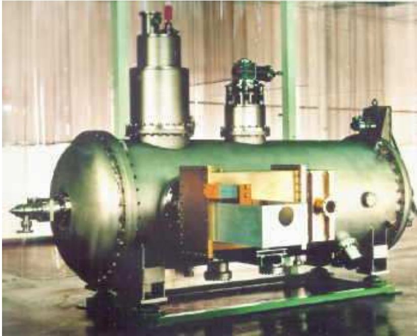
Abbildung 7.1: JAERI-Beschleunigungsmodul [1]: Zu sehen sind im Vordergrund die Zuführung der 500 MHz-Hochfrequenz über den Rechteckhohlleiter und auf dem Modulkopf die Zuleitungen für die Flüssigheliumversorgung und die Diagnose- und Überwachungssysteme (Temperatur, Druck, Tunersystem, Koppelschleifen, usw.). Ferner sind Anschlüsse für die Pumpen des Resonator- und des Kryostatvakuum vorhanden. Rechts und links endet das Modul mit den Flanschen der Strahlrohre.
