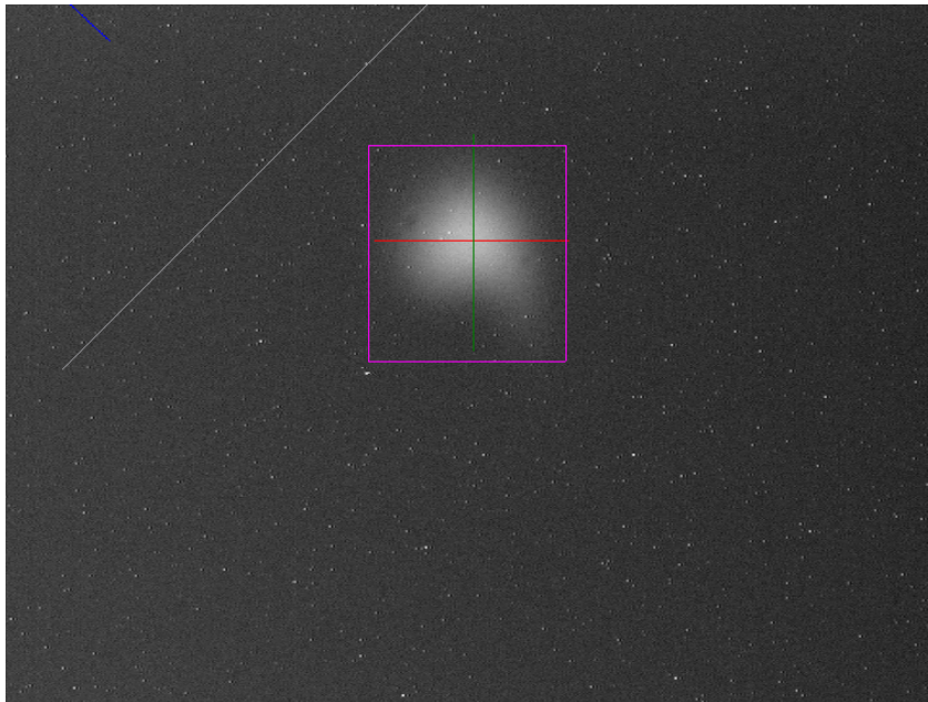
Abbildung 5.15: Emittanzbestimmung am Booster-Synchrotron. Der rosafarbene Kasten bestimmt den Bereich in dem eine Gaußfunktion an die Intensitätsverteilung angepasst wurde. Zur Bestimmung dieser werden die Pixel der Kamera vertikal bzw. horizontal aufsummiert.
